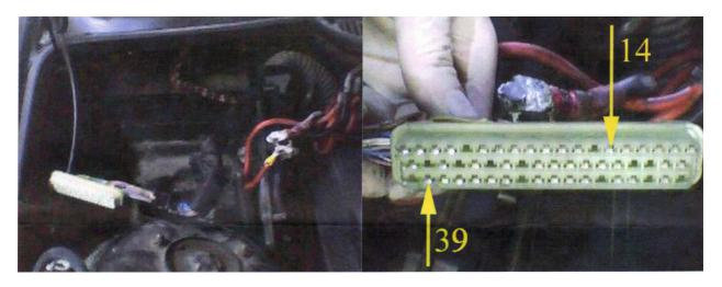
Dazu ein weißes Kabel an PIN 14 und ein weißes Kabel der Tuningbox an PIN 39 des Steuergeräts anschließen.
