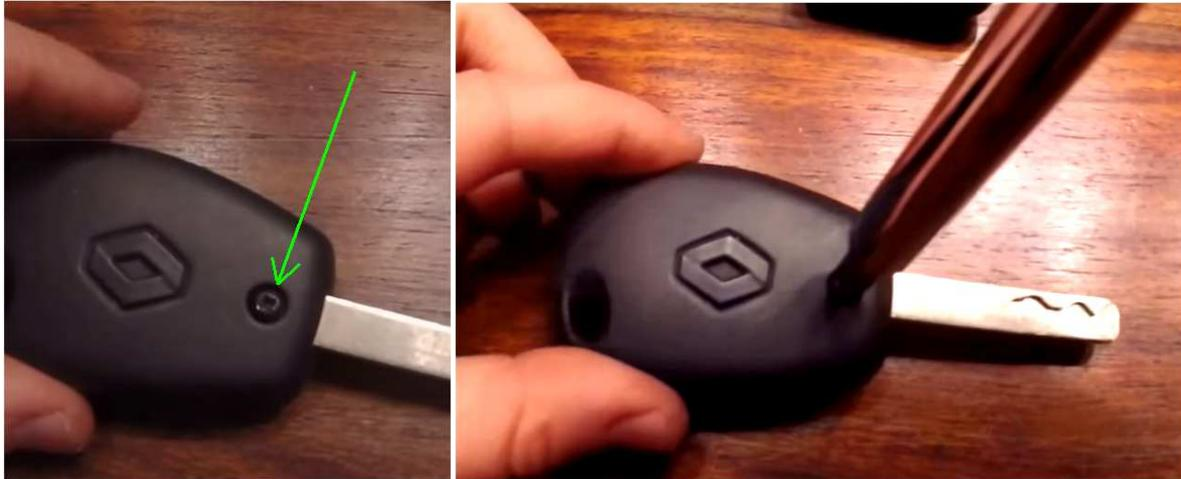
Oben an der Stelle, wo man den Schlüsselring anbringen kann, hat das Gehäuse eine kleine Ausnehmung. Diese Eignet sich gut, um das Gehäuse aufzuhebeln.
