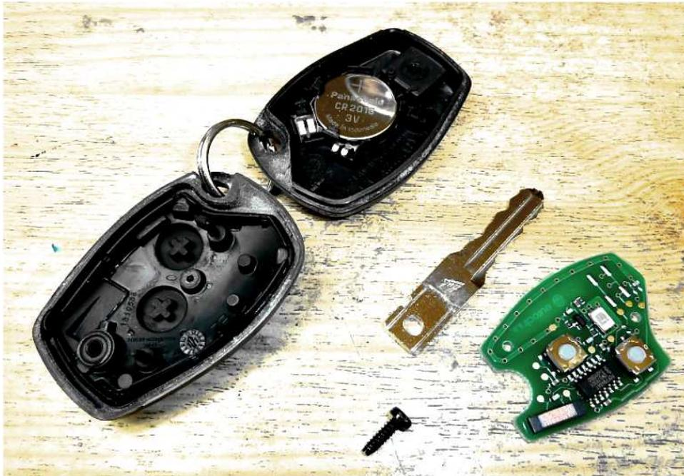
Die Platine lässt sich leicht heraus hebeln und man kann diese in das neue Gehäuse geben. Zuvor sollte man aber im neuen Gehäuse die Batteriekontakte einsetzen:
