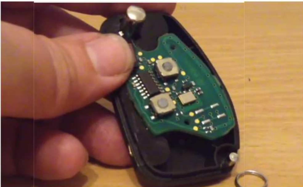
Die Platine passt exakt in die Ausnehmung vom Gehäuse. Nun vorsichtig das Gehäuseoberteil mit den Tasten aufsetzen und zusammen drücken.
