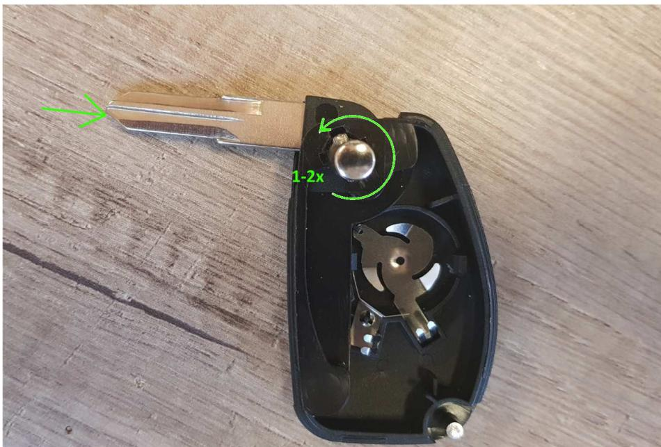
Danach den Druckknopf ganz hinein drücken und den Schlüsselbart zuklappen. Jetzt ist die Feder vorgespannt und der Schlüsselbart klappt wieder automatisch aus sobald man den Knopf drückt.
