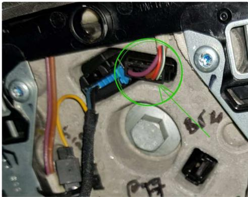
Damit man die gesamte Schaltereinheit mit dem Kabelsatz heraus nehmen kann, muss man diesen abstecken. Der Kabelsatz von den Lenkradtasten und jener vom Airbag haben 2 getrennte Stecker. Hier am Foto der rechten von den 2 Steckern ist jener für die Schalter (z.B. nicht beim F25). Diesen vorsichtig lösen. Auf der rechten Schaltereinheit
