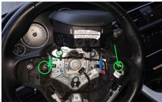
Bei Fahrzeugen mit Schaltpanels verdecken diese meist die Befestigungsschrauben der Schaltereinheiten. Dach muss man die Schaltpanels zuvor von innen abschrauben. Erst dann gelangt man zu den Schrauben der Schaltereinheit links und rechts.
