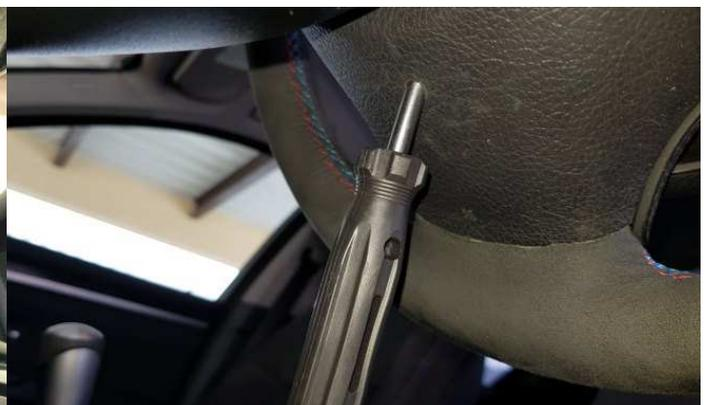
Unter dem Lenkrad ist eine kleine runde Öffnung, in die man z.B. mit einem kleinen flachen Schraubendreher hinein kommt. Unter der Öffnung befindet sich die Verriegelung vom Airbag. Durch das Hinauf drücken löst sich die Spange, mit der der Airbag verriegelt ist und man kann ihn nach vorne heraus klappen. Den Schraubendreher möglichst senkrecht halten, damit man die Verriegelung auch erwischt.
