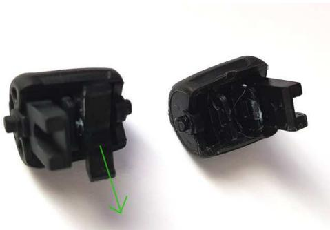
Im alten Tastenrad befindet sich noch der Anschlag für die Federung (damit es immer von selbst in die Ausgangsposition zurück geht). Auf diesen drück im zusammengebauten Zustand das weiße Gegenstück in der anderen Gehäusehälfte mittels einer Feder. Den Anschlag aus dem alten Tastenrad einfach herausziehen und in das neue geben.
