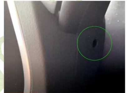
Lenkrad hat seitlich 2 Verriegelungen. Diese müssen gelöst werden, damit man den Airbag heraus bekommt. Hinten ist links und rechts seitlich jeweils eine kleine Öffnung, in die man z.B. mit einem kleinen flachen Schraubendreher hinein kommt. Unter der Öffnung befindet sich die Verriegelung vom Airbag. Durch das hinein drücken löst sich die Spange, mit der der Airbag verriegelt ist und man kann ihn nach vorne heraus klappen.
