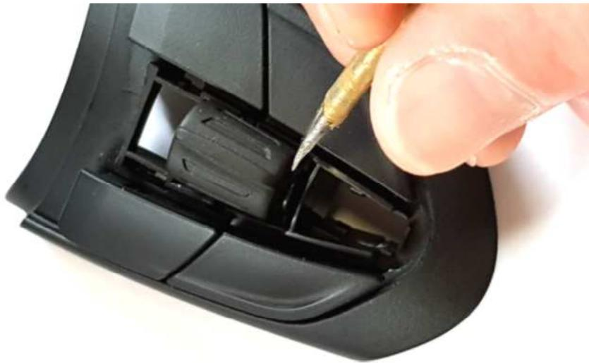
Ist die Chromspange entfernt, kann man das Tastenrad aus seiner Halterung heraus nehmen. Vorsichtig mit einem flachen Gegenstand das alte Tastenrad entfernen und dann das neue einfach einsetzen und auf Gängigkeit prüfen.
